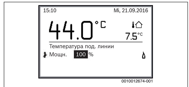
Рис. 29 Активен режим "трубочист"
