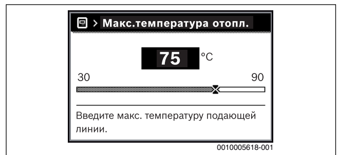
Рис. 25 Установка максимальной температуры подающей линии
