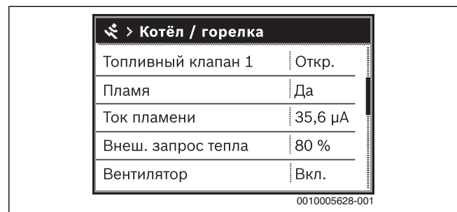
Рис. 32 Ток ионизации (пламени) в меню мониторинга
