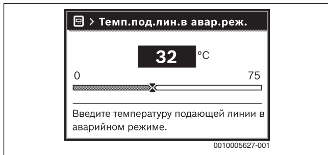
Рис. 42 Температура подающей линии для аварийного режима
