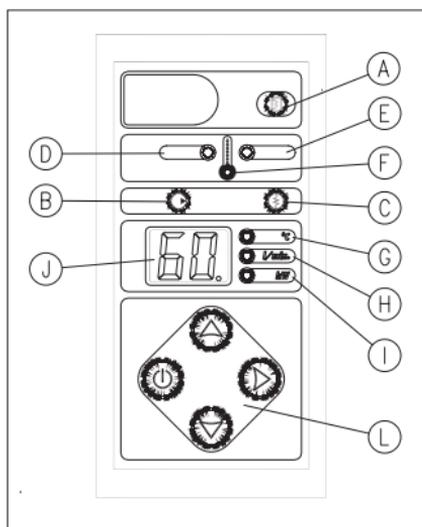
На панели управления котла расположены две рабочие зоны – сигнализационная (элементы A - K) и зона управления (L). Потребитель может выбрать один из трех рабочих режимов: режим простоя, зимний (отопление или отопление + работа на бойлер косвенного нагрева) и летний (работа на бойлер косвенного нагрева).
