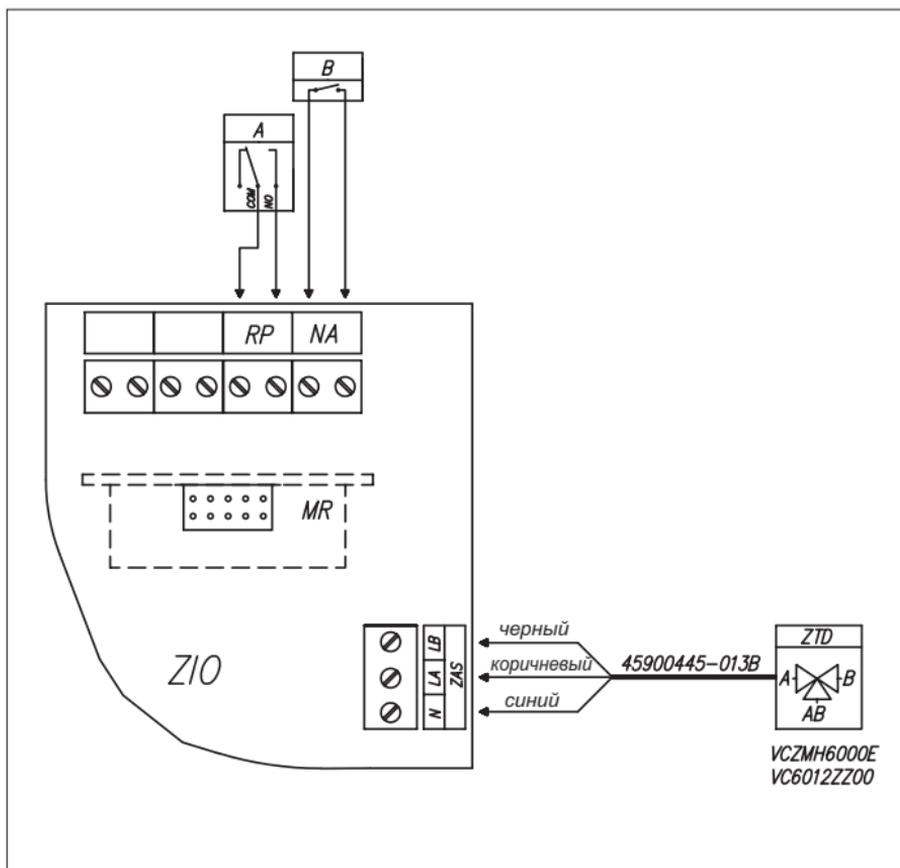
**Комнатный регулятор температуры (клеммы RP)** – разомкнутые клеммы выключают нагрев. Вход сигнальный, отвечает за управление работой котла зависимо от температуры в помещении.
