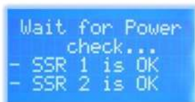
Рис. 7 – Экран проверки питания и твердотельных реле (SSR)
