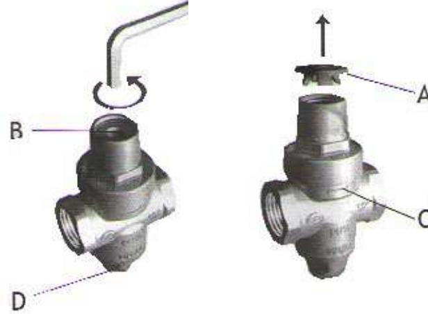
6.5. Настройка редуктора производится при расходе, близком к нулевому, но не нулевому. Это значит, что все водоразборные краны системы должны быть закрыты, а на одном из приборов оставлен минимально возможный струйный расход (расход, при котором выходящая из излива струя не разделяется на отдельные капли).
