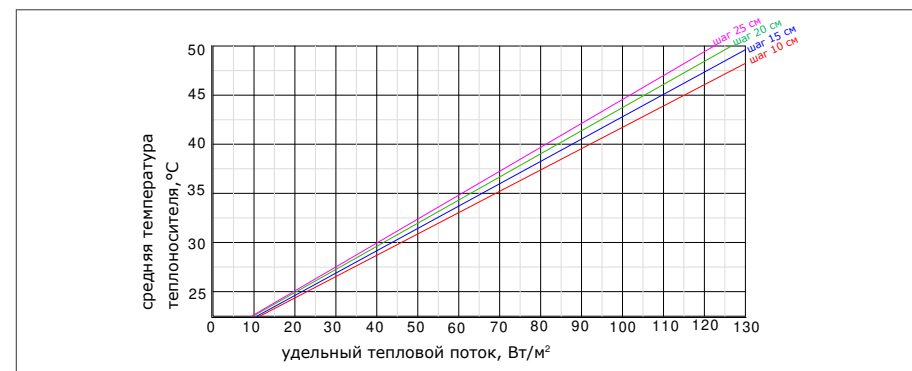
Рис. 6.5.5. Зависимость теплового потока от средней температуры теплоносителя (стяжка 30 мм; ковролин; труба 16x2,0)
