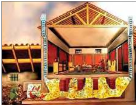
Рис. 1.4.1. Гипокаустум Древнего Рима
