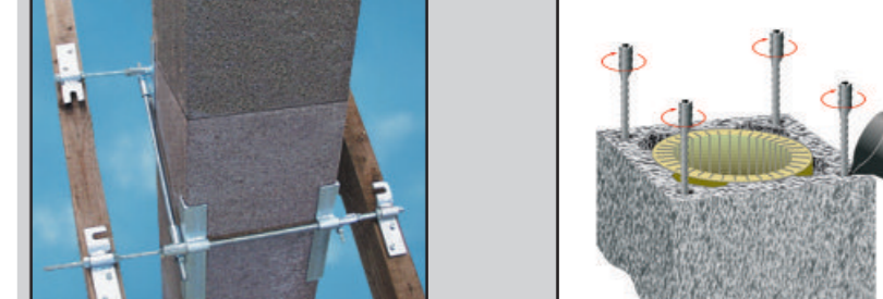
9.1 Дымоход должен быть стабильно закреплён между стропилами, используя крепежные «Schiedel» (инструкция сборки приложена к креплениям). 9.2 Если дымоход поднимается выше кровельного покрытия более, чем на 1.2 метра, он должен быть армирован. Рекомендуется использовать армирующий комплект «Schiedel» (инструкция сборки приложена к арм. элементам).
