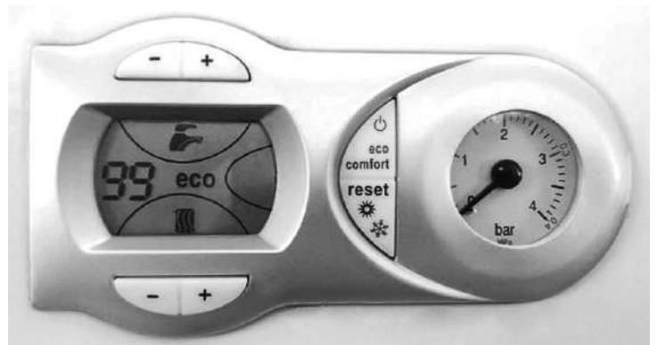
Рис. 14. Режим TEST (мощность системы отопления = 100%, индикация - 99)
