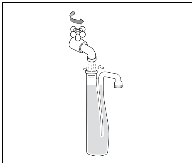
Рис. 16 Заполнение сифона водой
