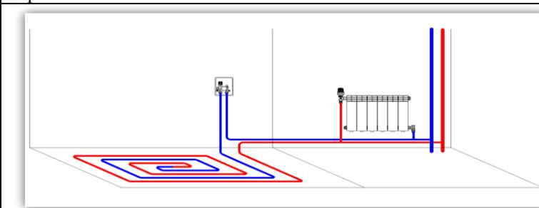
**ICBOX 2.0.** «Теплый пол» в высокотемпературной системе. Температура в помещении регулируется термоголовкой (высота установки монтажного комплекта -1,2 м)..
