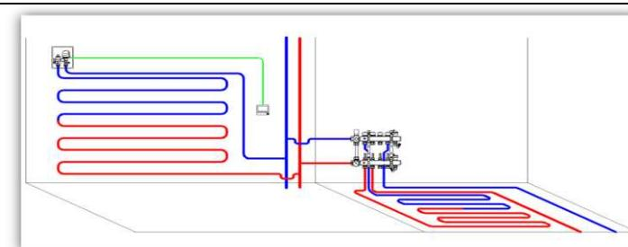
*ICBOX 5.0.* «Теплая стена» в низкотемпературной системе. Температура в помещении регулируется сервоприводом под управлением комнатного терmostата.
