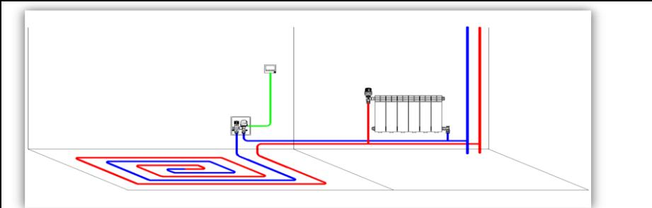
**ICBOX 1.0.** «Теплый пол» в высокотемпературной системе. Температура в помещении регулируется сервоприводом под управлением комнатного терmostата.
