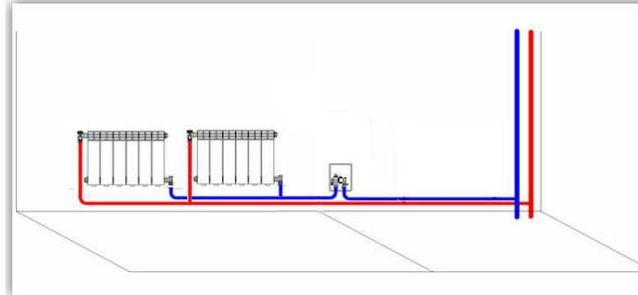
*ICBOX 4.0* Терморегулирование группой радиаторов в высокотемпературной системе отопления
