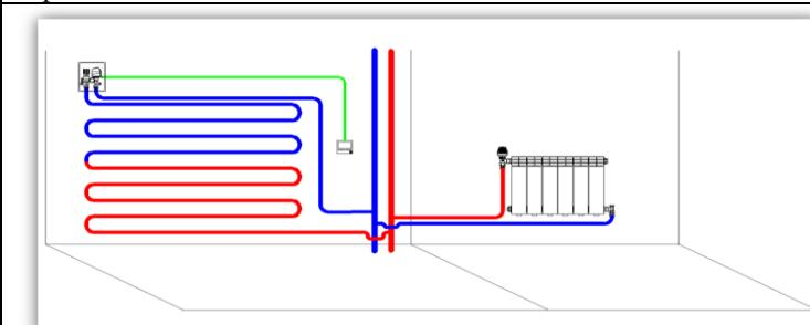
**ICBOX 1.0.** «Теплая стена» в высокотемпературной системе. Температура в помещении регулируется сервоприводом под управлением комнатного терmostата.
