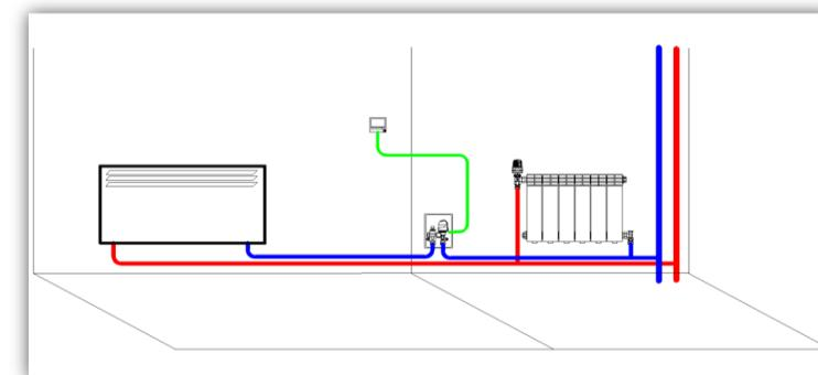
*ICBOX 5.0.* Нагревательный прибор в высокотемпературной системе. Температура в помещении регулируется сервоприводом под управлением комнатного терmostата.
