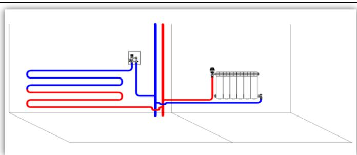
*ICBOX 2.0.* «Теплая стена» в высокотемпературной системе. Температура в помещении регулируется термоголовкой (высота установки монтажного комплекта 1,5 м).
