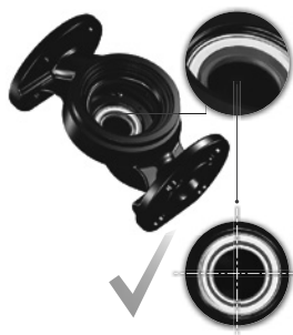
Рис. 15 Правильно выровненная система уплотнений
