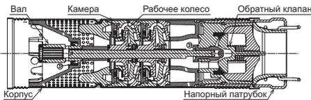
Рис. 1 Вид насосов SQ и SQE без электродвигателя
