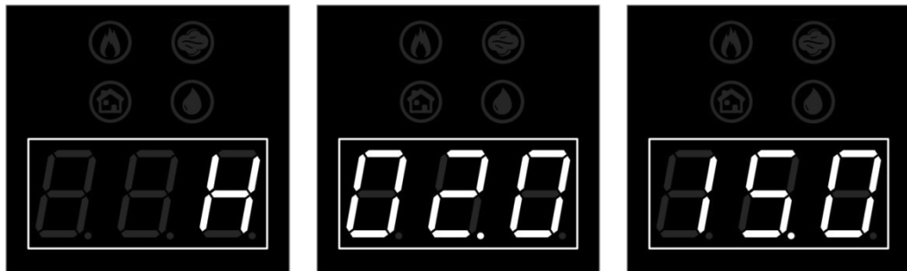
Рисунок 8 — Установка пауз включения и выключения насоса
