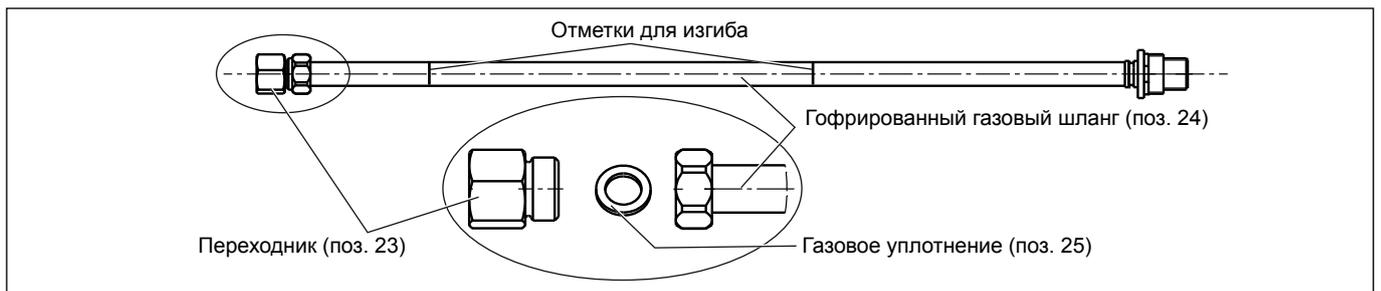
**Внимание** Применение газовой линии разрешено при макс. рабочем давлении 150 мбар.
