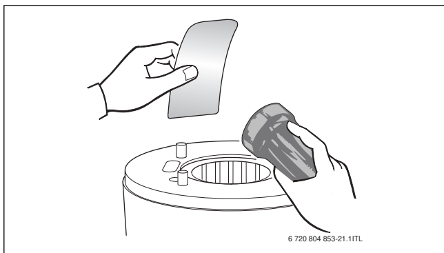
Рис. 52 Проверка наличия грязи в теплообменнике
