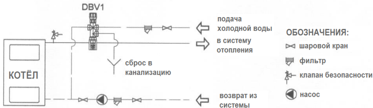
Рис.6 Схема установки с двухходовым клапаном безопасности DBV1.
