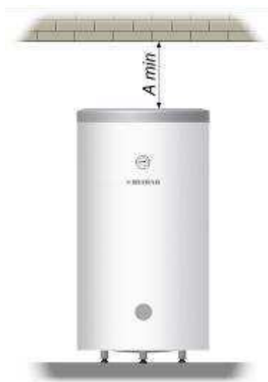
Рис. 4 Минимальное расстояние для обслуживания магниевого анода
