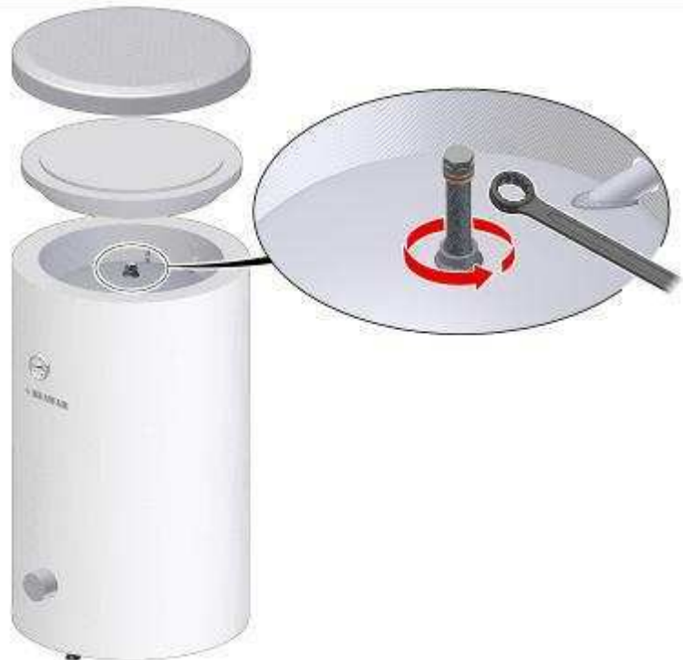
Рис. 8 Замена магниевого анода
