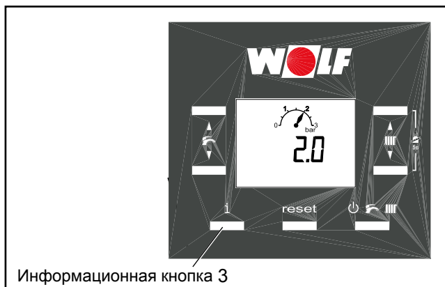
Рисунок: Индикация давления на дисплее системы регулирования
