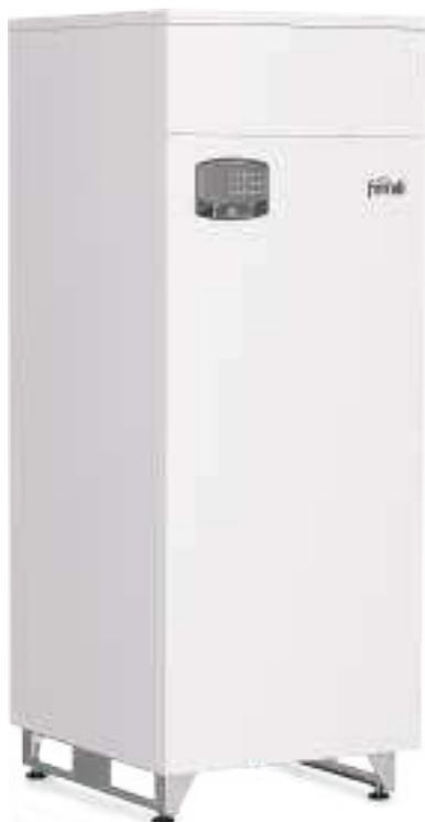
Котлы серии Quadrifoglio не имеют аналогов на рынке. Особенностью котлов этой серии является большое количество отопительной воды в теле котла и две обратки. Благодаря большому количеству воды котлы сами могут работать в качестве гидравлического разделителя. Котлы мощностью 70 кВт могут работать по протоколу OpenTherm с пультом ДУ ROMEO и датчиком уличной температуры.
