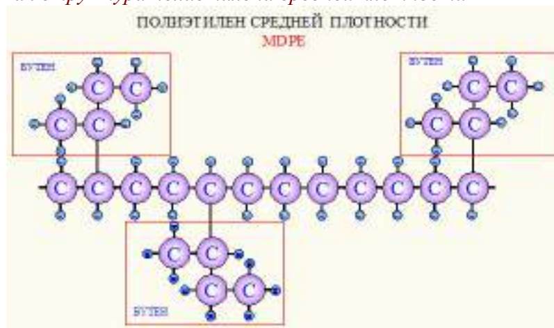
Рис. 2.1.р.4 Химическая структура полиэтилена средней плотности
