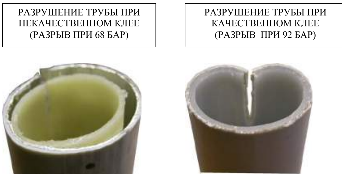
Рис.2.3.4.р.2 Вид среза МПТ после разрывных испытаний
