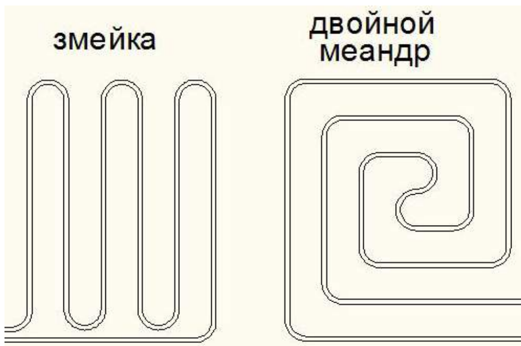
Рис.5.3.1.4. р.1 Способы раскладки петель теплого пола
