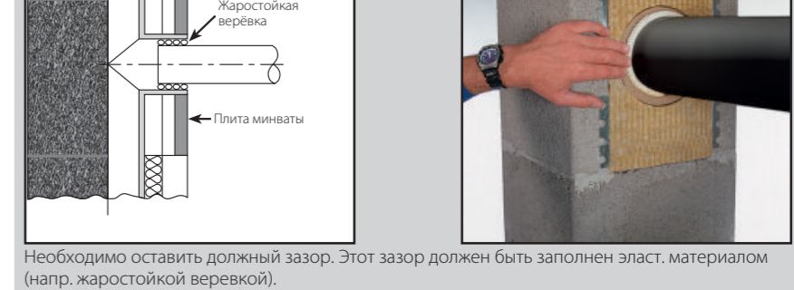
Необходимо оставить должный зазор. Этот зазор должен быть заполнен эласт. материалом (напр. жаростойкой ветовью).
