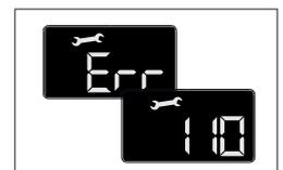
**Защитное отключение из-за низкого давления воды**
