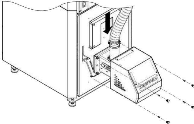
ШАГ 9. Установите корпус горелки с помощью металлических винтов. Закупорить отверстия пластиковыми заглушками
