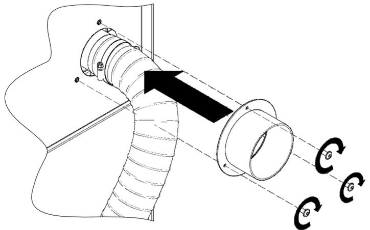
ШАГ 8. Установите засыпную гибкую трубу к выходу(трубе) бункера с помощью хомута крепления.
