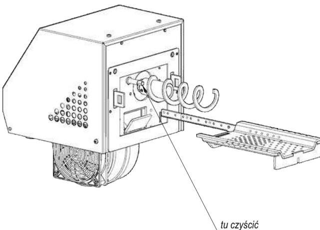
ШАГ 3. Очистить датчик пламени в указанном месте с помощью ткани, чтобы проверить прозрачность фотоэлемента датчика пламени. Сборку горелки осуществить в обратном порядке.
