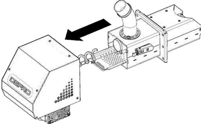
ШАГ 2. Вытяните заднюю часть горелки из камеры сгорания горелки, вместе с решеткой, корпусом шнека и датчиком обнаружения пламени. Эта процедура должна быть выполнена осторожно.
