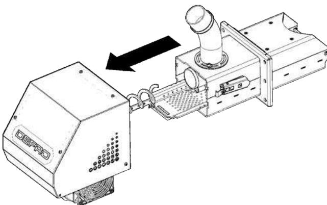
ШАГ 2. Вытяните заднюю часть горелки из камеры сгорания горелки, вместе с решеткой, корпусом шнека и датчиком обнаружения пламени. Эта процедура должна быть выполнена осторожно.
