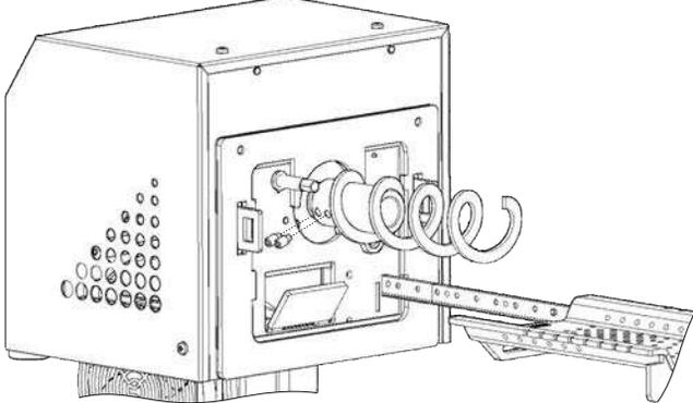
ШАГ 3. Снимите крепежные винты М6х12 крепящие шнек
