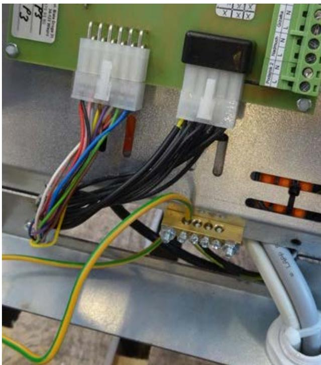
ШАГ 5. Подключить гнезда питания и заземления(провод желто-зеленый). Заблокировать провода и проверить изоляцию. Установить защиту горелки.
