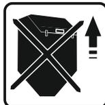
**Во время работы котла, крышка бункера должна быть закрыта. Возможно попадание пламени в бункер и возгорания!**
