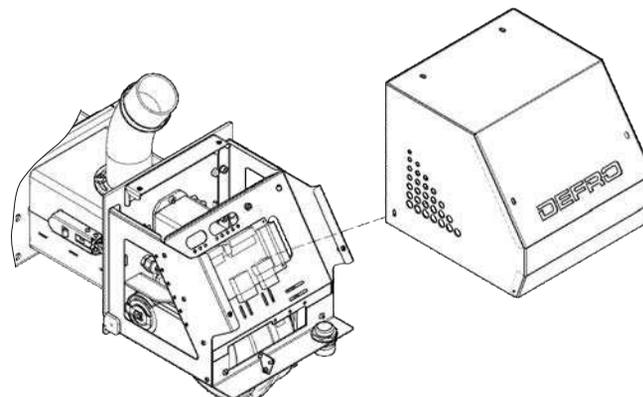
ШАГ 3. Снимите крышку горелки, открутив винты крепления.
