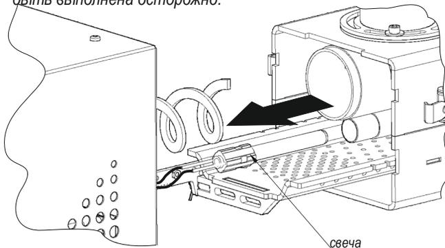
ШАГ 3. Извлеките свечу розжига из посадочного гнезда.
