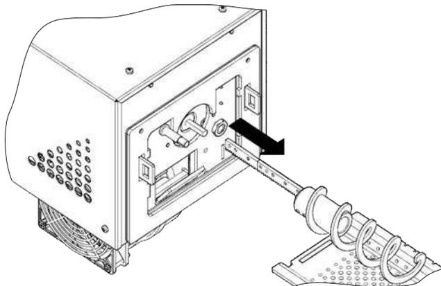
ШАГ 4. Высунте шнек со штока моторредуктора. Замените на новый. Выполнить сборку в обратном порядке.
