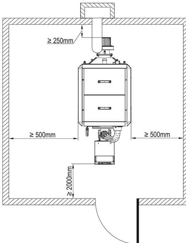
Рисунок 3. Установка котла в помещении котельной.
