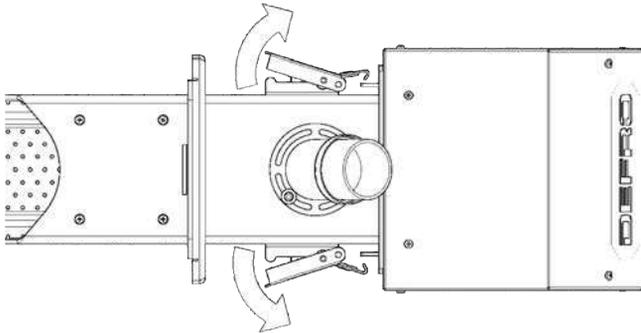
ШАГ 1. отцепить фиксирующие стопорные элементы по бокам задней части корпуса горелки.
