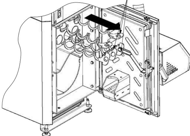
Rysunek 19. Sposób czyszczenia zawirowywaczy.
