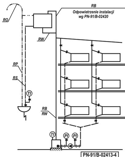
Рисунок 4. Схема защиты водной системы центрального отопления, состоящей из одного котла или теплообменника, верхняя часть, насос установлен на возврате. Схема защиты также может использоваться в следующих системах водного отопления:
