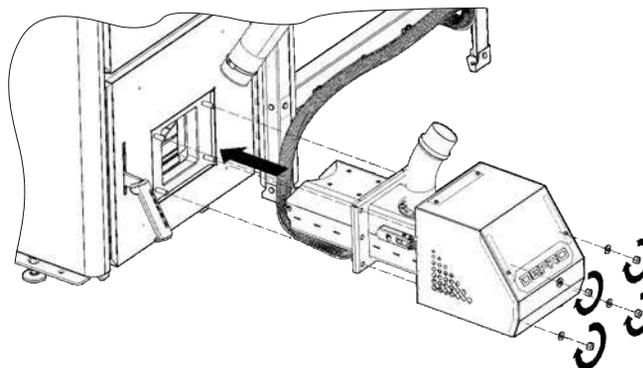
ШАГ 2. Вставьте горелку на винты крепления горелки, затяните с помощью гаек М8
