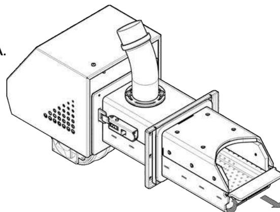
ШАГ 1. Удалите перегородку полки горелки, в соответствии с порядком и направлением стрелок на рисунке.
