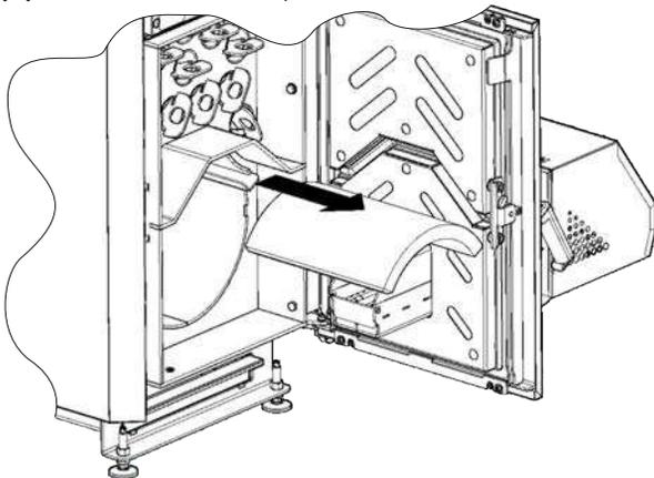
Рисунок 18. Монтаж керамики.
