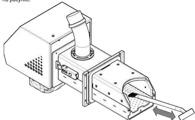
ШАГ 2. Очистить поверхность решетки, и камеру сгорания горелки в соответствии с рисунком выше
