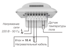
Рисунок 7. Схема подключения терморегулятора к сети
