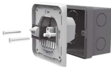
Рисунок 8. Установка терморегулятора в монтажную коробку
