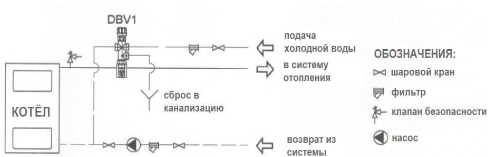
Рис.3 Схема системы с установленным двухходовым клапаном безопасности DBV1.
