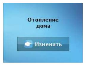
Вид режима работы — показывает активный режим работы насосов (вид возможен исключительно в случае пеллетного котла) — нажав эту опцию возможно изменить режим работы насосов. Можно выбрать следующие режимы работы насосов: Отопление дома, приоритет бойлера, параллельные насосы, летний режим с нагревом и летний режим без нагрева. Подробное описание режимов работы насосов находится в руководстве контроллера котла.
