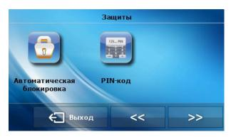
Нажав иконку Автоблокировка отображается панель для включения и выключения блокировки.
