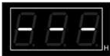
Рисунок 4. Показания индикатора при неисправности или отсутствии датчика температуры.
