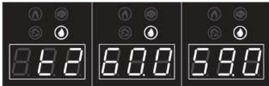
Рисунок 3 — Настройка границ температуры теплоносителя
