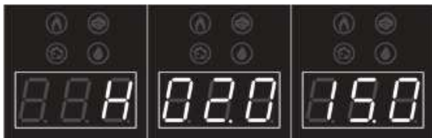
а) б) в) Рисунок 8 — Установка пауз включения и выключения насоса
