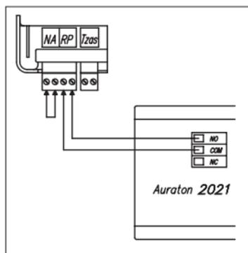
**Комнатный регулятор температуры (RP)** - вход сигнальный, отвечает за управление работой котла зависимо от температуры в помещении.
