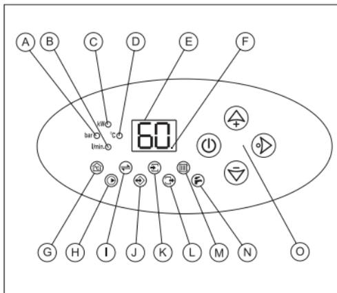
На поверхности панели управления выделены 2 рабочие зоны: сигнализирования (элементы A-N) и управления (O). Потребитель имеет выбор (касается котлов ЕКСО.LN2 и ЕКСО.L2) между тремя рабочими режимами: простоя, зимний (отопление или отопление + работа на бойлер ГВС) и летний (работа на бойлер ГВС). Для котлов ЕКСО.LN2...р и ЕКСО.L2...р два режима: простоя и зимний (отопление). Переключение между рабочими режимами осуществляется при помощи кнопки (⏻).
