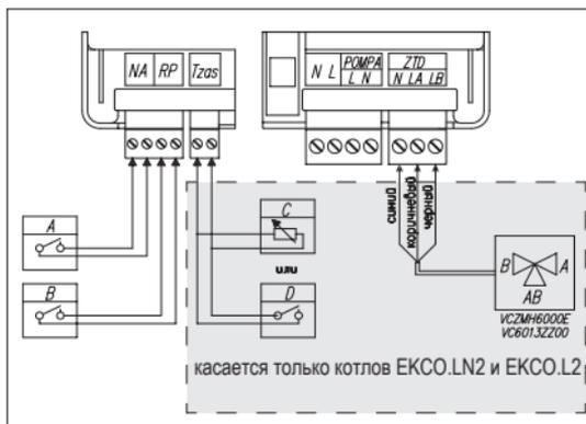
прохода между входом „АВ” и выходом „А”. Обозначение входа „АВ и выходов „А”, „В” находится на клапане. При таком подключении выход „В” служит для подачи теплоносителя на отопительную систему, а выход „А” для подачи теплоносителя на бойлер ГВС. Внимание, для активирования опции ГВС следует поступать согласно описанию в п. Расширенные настройки. Установить температуру теплоносителя на бойлер ГВС (50 - 85°C).
