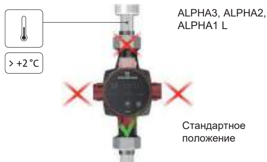
Рис. 17 Возможное положение блока управления для системы отопления
