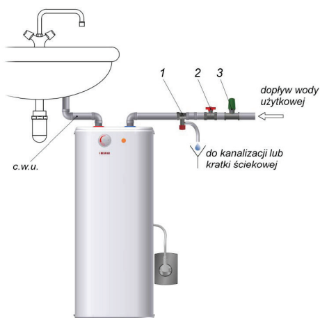
Rys. 10 Schemat hydrauliczny podgrzewaczy podumywalkowych OW-E 5/10/15.
