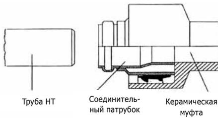
б) Вырежьте участок трубы равный длине фитинга плюс глубина вставки в раструб. Наденьте длинную муфту на трубу до упора и на другом конце трубы закрепите тройник подвижной муфтой. Затем гладкий конец длинной муфты задвиньте в раструб тройника (рис Б).
