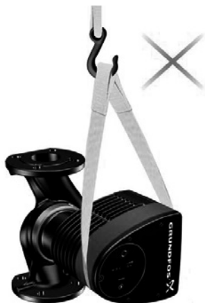
Рис. 8 Неправильный способ строповки насоса Дополнительная информация по перемещению оборудования приведена в Кратком руководстве (Quick Guide).
