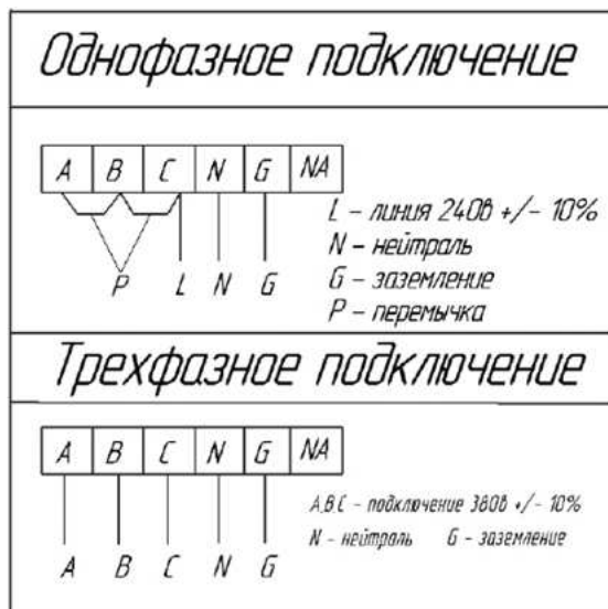
Рис. 4. Схемы подключения электрического котла к электросети.
