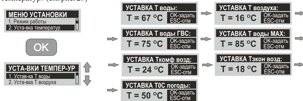
Рисунок 29. Установка температурных параметров.
