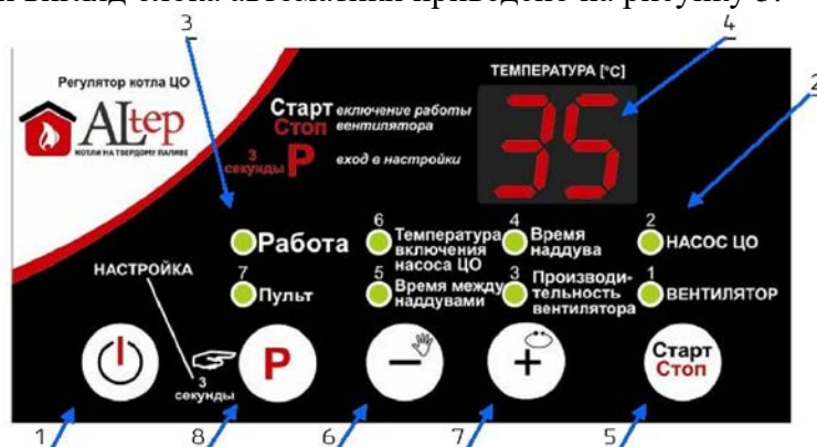
Рисунок 3 – Зовнішній вигляд передньої панелі контролера
