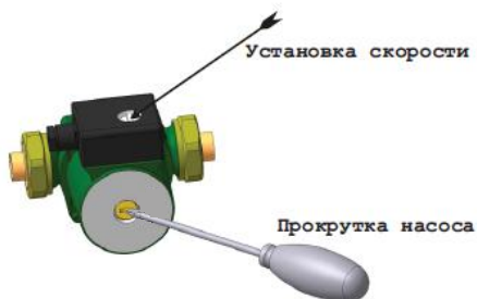
Рис. 24 Схема обслуживания насоса.
