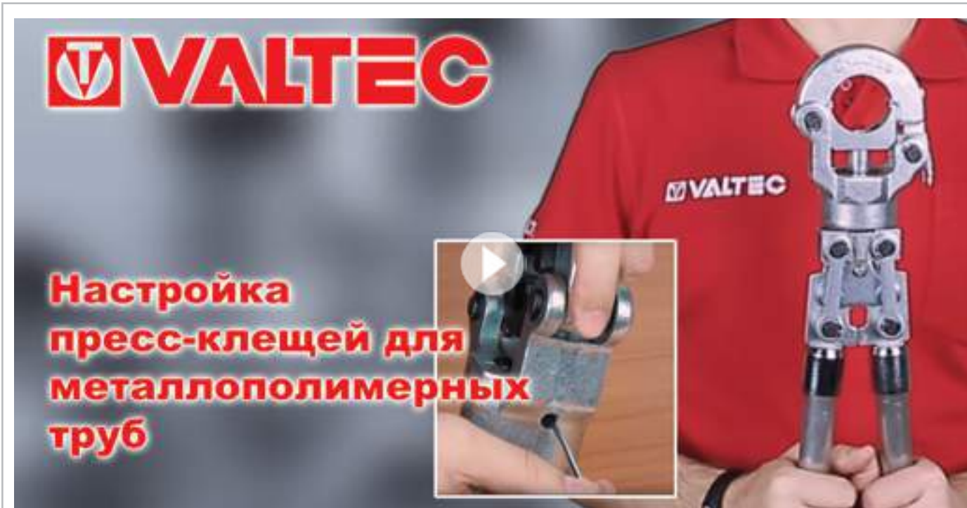
Настройка пресс-клещей для металлополимерных труб.
