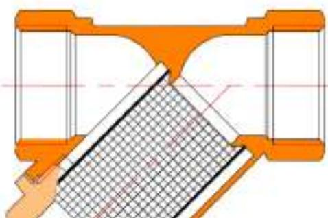
4.2. При установке следует соблюдать осторожность, не допуская замятия краев фильтрующего элемента.
