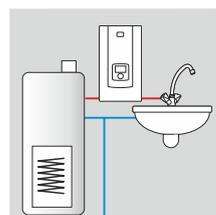
Возможность догрева предварительно нагретой воды. Температура воды на входе до 70°C.
