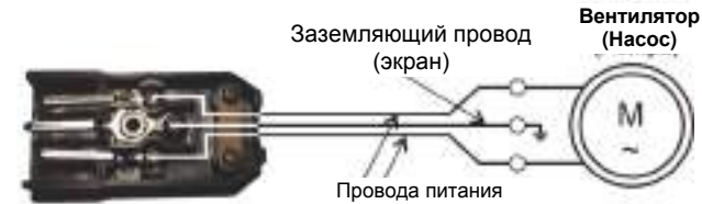
Рис. Подсоединение проводов от вентилятора/насоса к вилке
