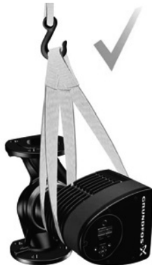
Рис. 7 Правильный способ строповки насоса
