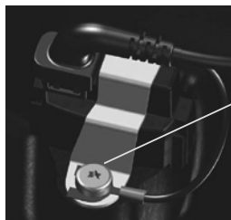
Рис. 44 Заземляющий провод датчика
