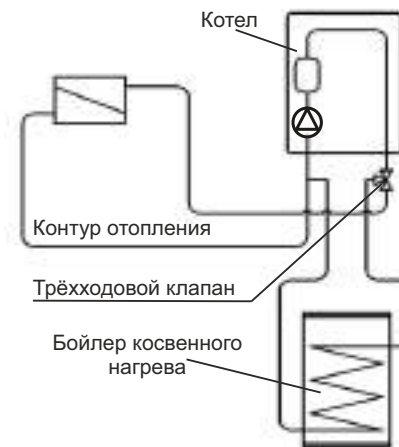
Рисунок 25. Гидравлическое подключение комплекта ГВС EVAN AQUA.
