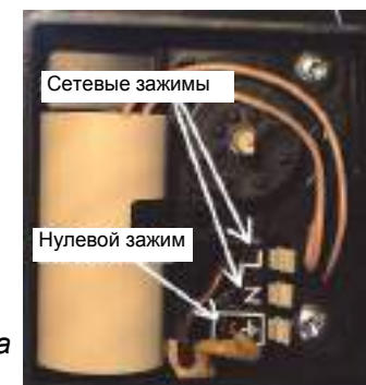
Рис. Подсоединение проводов к насосу Ц.О.
