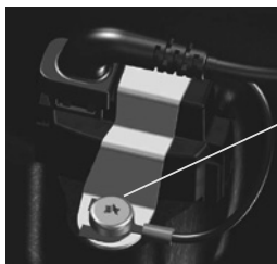
Рис. 44 Заземляющий провод датчика
