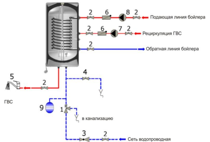
Рис . 3 Схема подключения W-E 120-140.12 P
