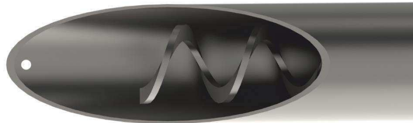
Рис.7. Монтаж спирали питателя.
