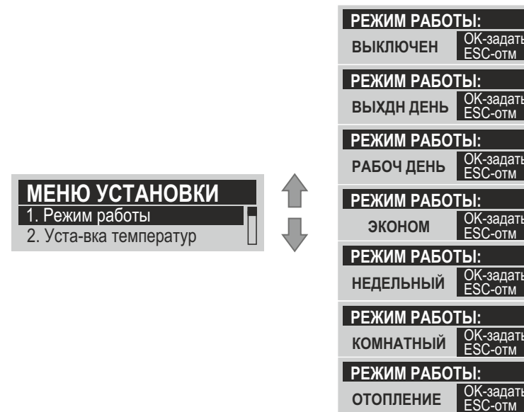
Рисунок 27. Отображение на экране режимов работы прибора.
