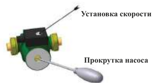
Рис. 30 Схема обслуживания насоса.
