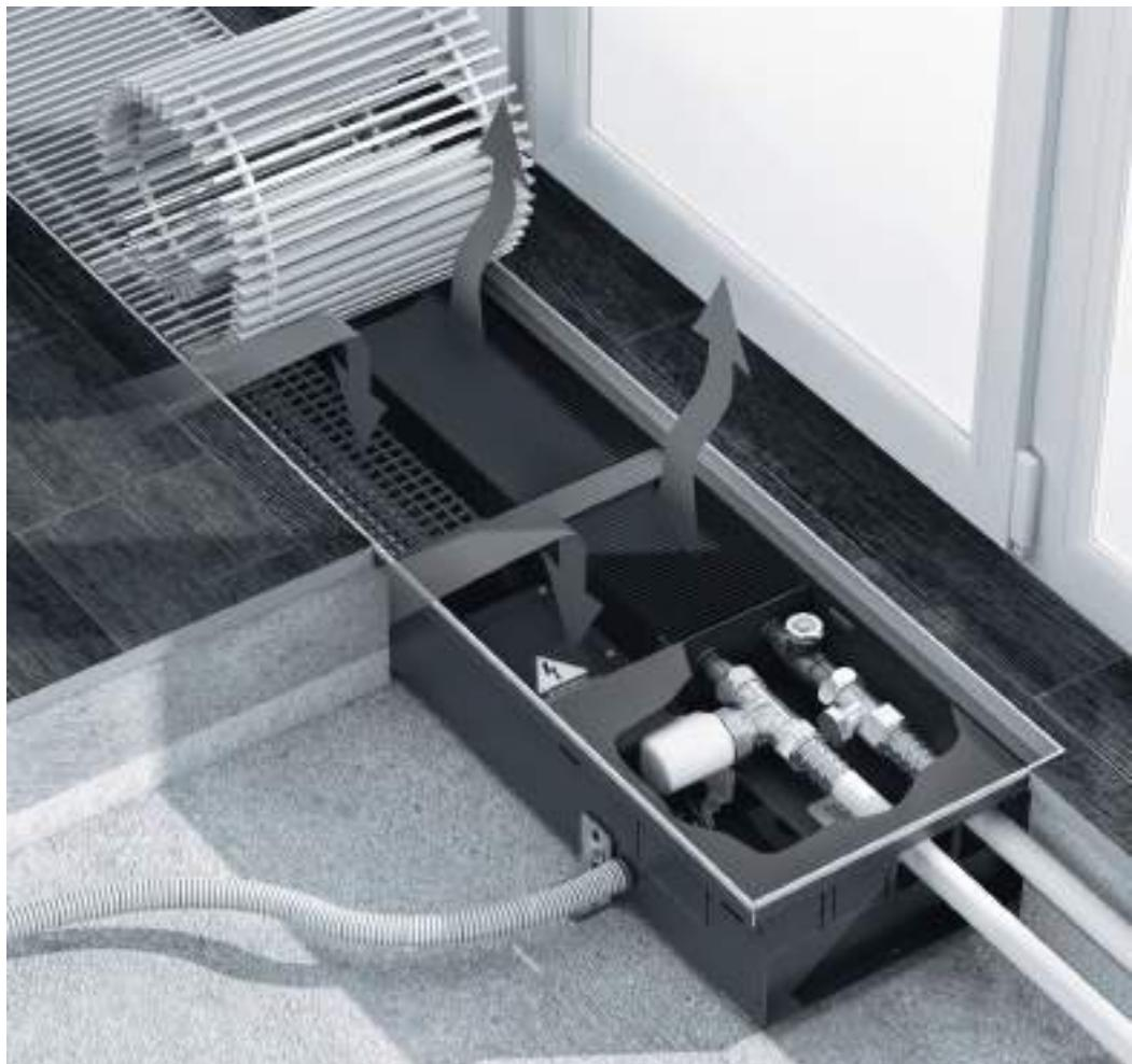
Встраиваемый в пол конвектор Qtherm — готовый к монтажу отопительный прибор, работающий по принципу принудительной конвекции. Конвектор Qtherm комплектуется тангенциальными вентиляторами с энергосберегающими EC-двигателями постоянного тока 24 В и микропроцессорным регулятором с возможностью плавного изменения скорости вращения вентиляторов, работы в автономном режиме, подключения к настенному терморегулятору или к системе «умный дом», а также управления сервоприводом вентиля.
