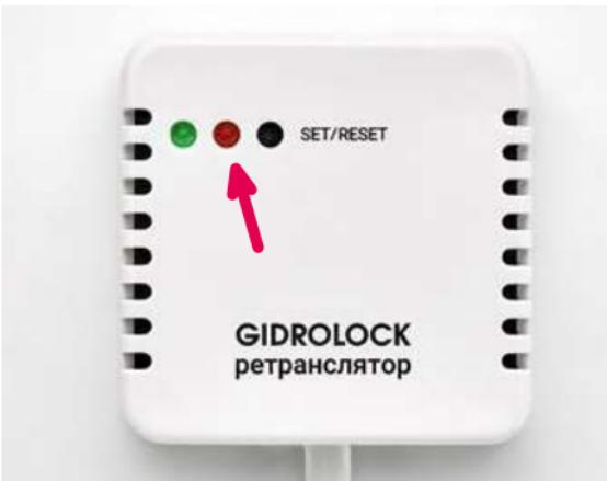
**ВНИМАНИЕ!** Когда процесс ознакомления завершится, красный светодиод на радиореле моргнет несколько раз. Количество вспышек светодиода соответствует записанному в память ретранслятора порядковому номеру радиодатчика WSR.
