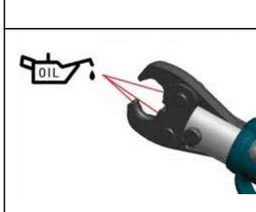
6.10. После завершения работы с инструментом капните каплю машинного масла на ролики штока.
