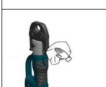
6.11. Перед укладкой в чемодан протрите инструмент сухой ветошью.
